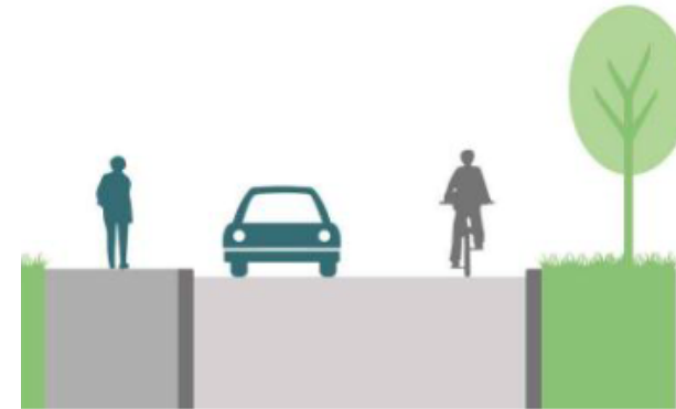
Kuva 6: Kävelyn ja pyöräilyn paikallisreiteillä pyöräily on osoitettu useimmiten ajoradalle. Siirtymät pää- ja aluereittien sekä paikallisreittien välillä suunnitellaan siten, että pyöräilijä voi sujuvasti siirtyä ajoradan ja pyörätien välillä. Lähde: Väylävirasto.
